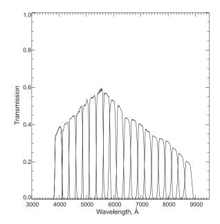
**Рис. 1.** Набор фильтров 1-м телескопа Шмидта БАО НАН. Пропускание фильтров измерено в F/2 с учетом спектральной чувствительности ССD-детектора.
