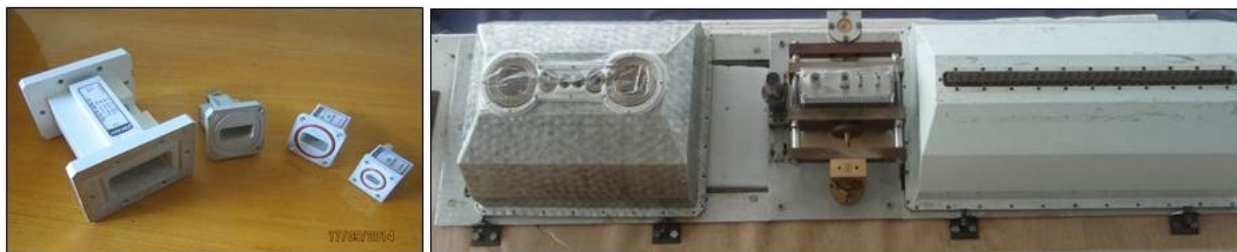
Рис. 41. Слева - линейка неохлаждаемых МШУ, внедренных на радиотелескопе РАТАН-600; справа – комплекс радиометров облучателя №2.
