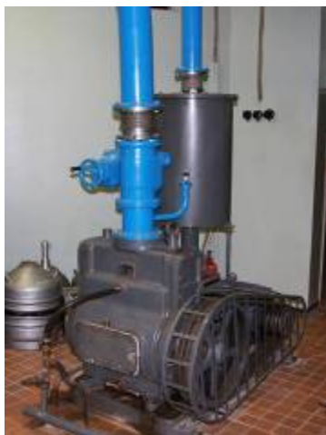
Рис.1. Насос форвакуумный ВН-6Г (20кВт, 360об/мин, 50мк.рт.ст, 155л/сек)
