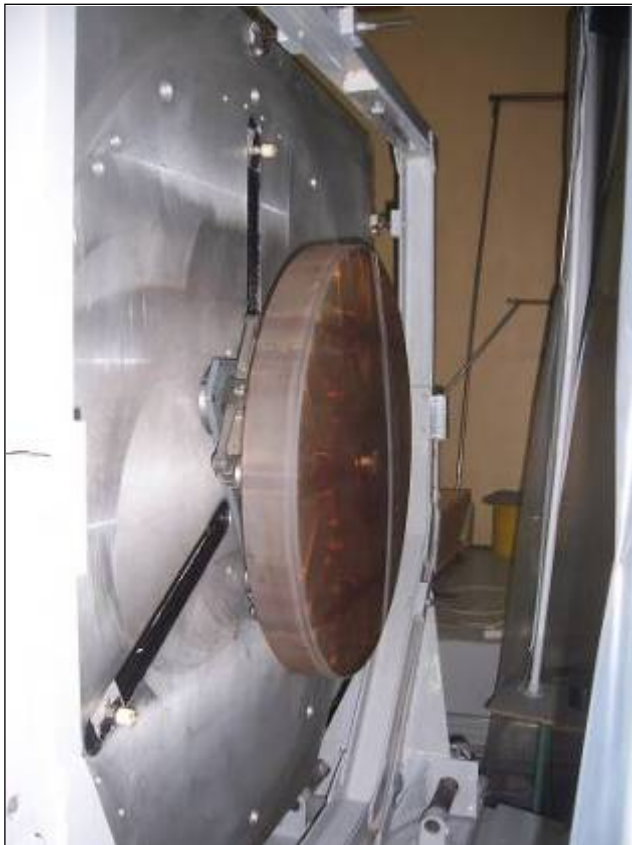
Рис.22. Вид оптической детали для проведения контроля рабочей поверхности главного зеркала БТА.
