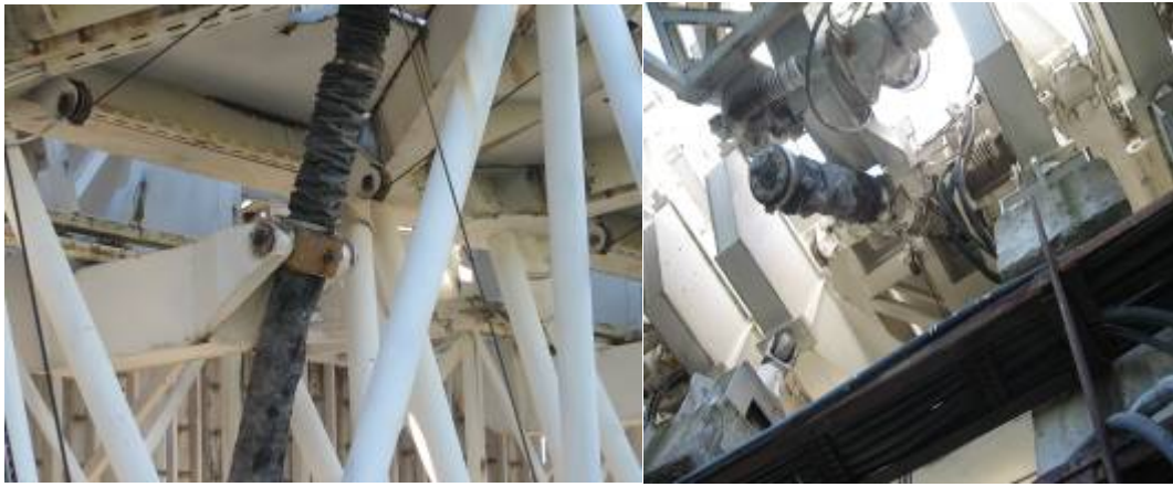
Рис 27. Вид винтовой пары в сборе на щитах плоского (слева) и кругового (справа) отражателя.
