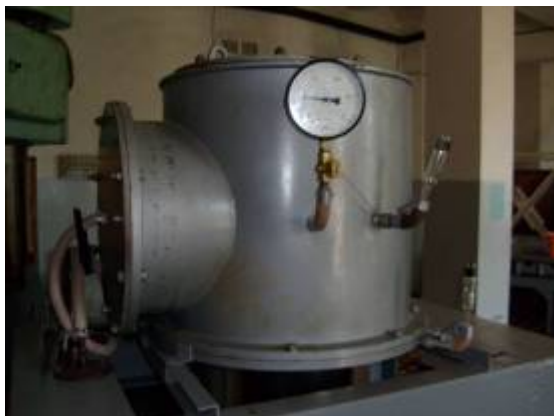
Рис.12. Г-образный затвор с манометром и лампами контроля вакуума (предварительного и высокого).
