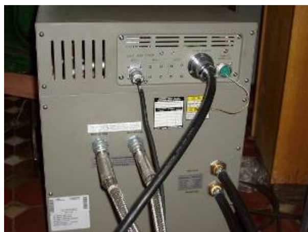
Рис.11. Компрессор крионасоса 9600с системой водяного охлаждения.
