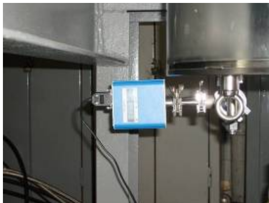
Рис.13. Широкодиапазонный вакуумметр Granville-Philips Micro-ION Plus с диапазоном измерений 5 \times 10^{-9} торр – 1000торр.
