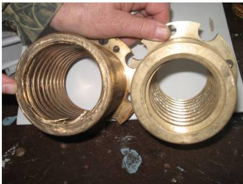
Рис 26. Изношенная (сломанная) и новая гайки СВГ.
