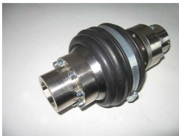
Рис.31. Вид разработанного шарнира равноугловых скоростей осей.
