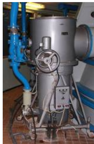
Рис.2. Насос диффузионный ВА-8-4-пр. ( 5 \times 10^{-7} мм.рт.ст., 2500л/сек)
