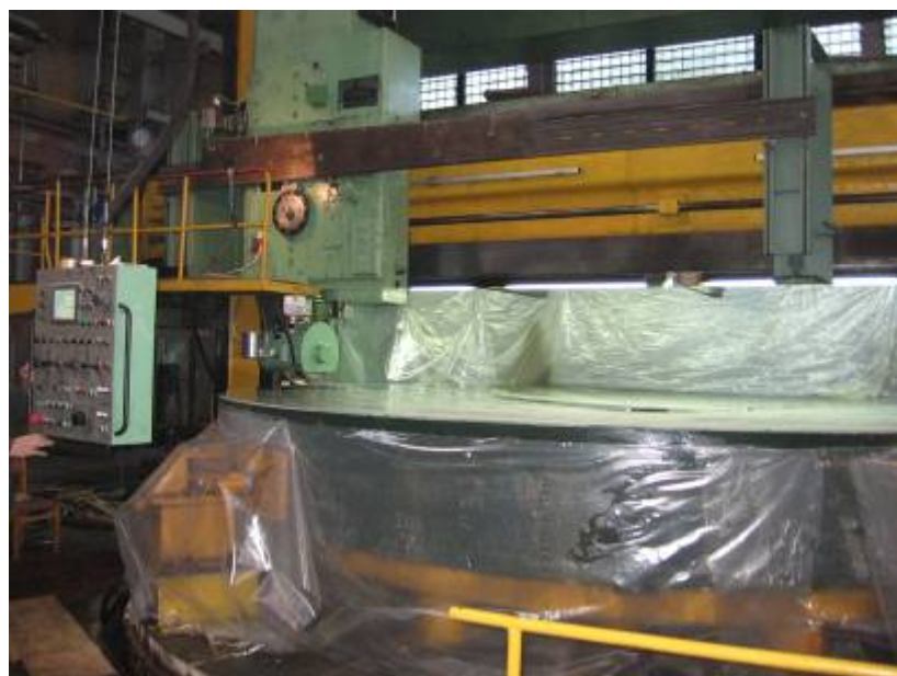
Рис.20. Общий вид заготовки ГЗ БТА на станке во время обработки.
