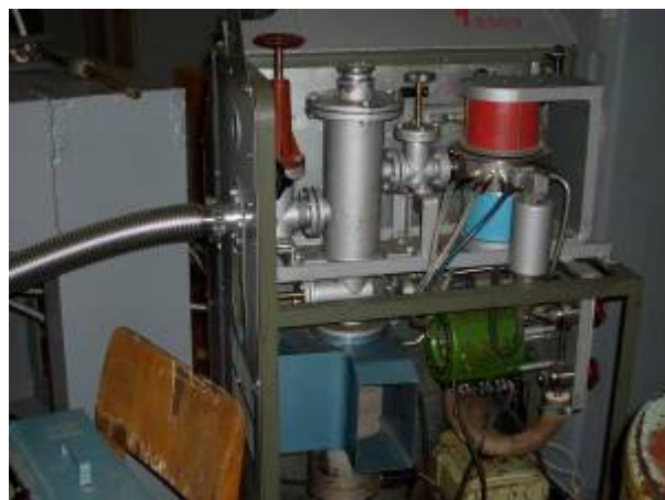
Рис.9. Низковакуумная система на базе ПТИ: форнасос с азотной ловушкой.
