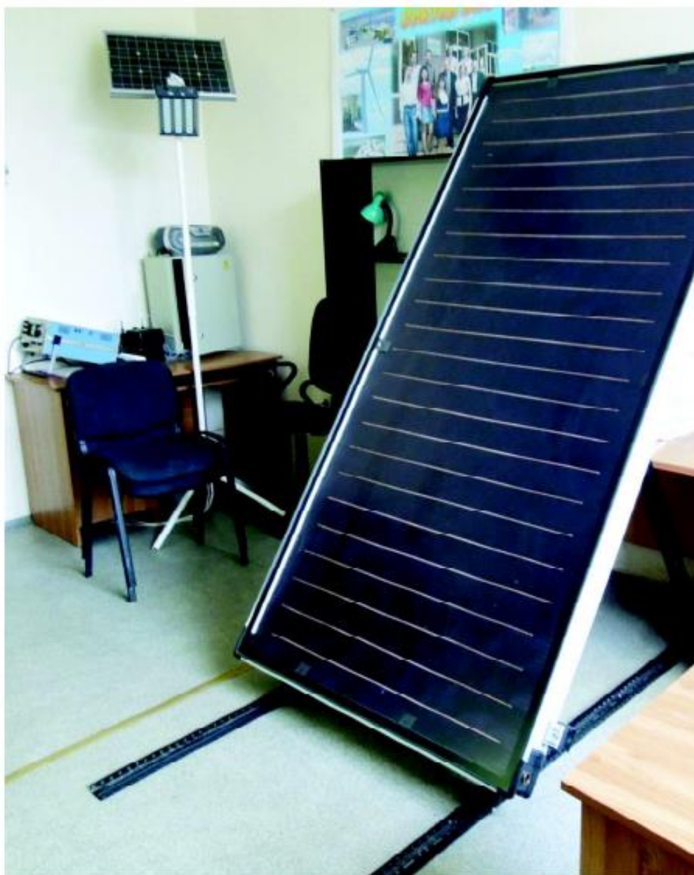
Рисунок 24 – Плоский солнечный коллектор KAIROSP-2.5-IV производства «Аристон» (Италия)
