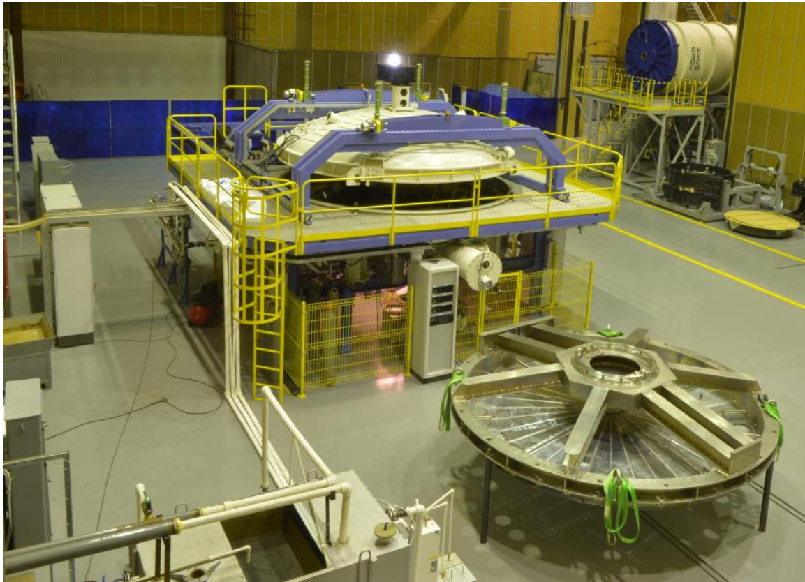
Рис.1. Установка для нанесения отражающих покрытий на детали диаметром до 4 м.
