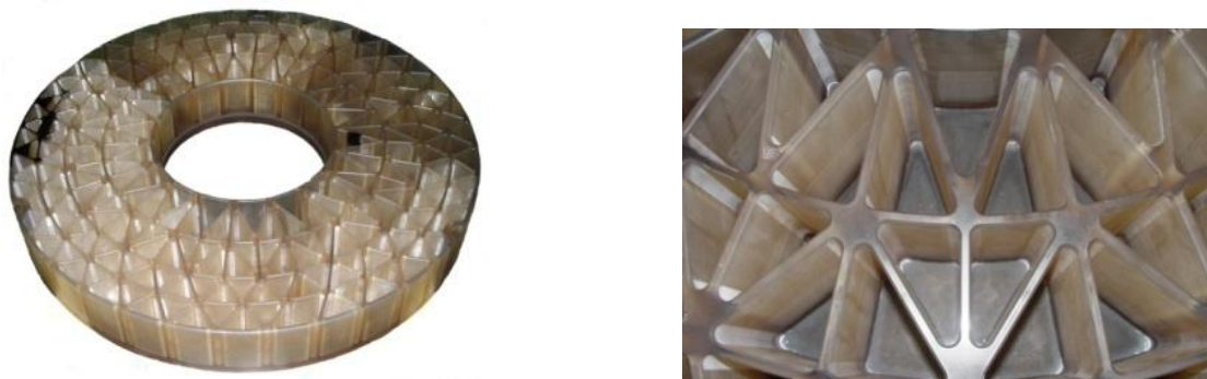
Рис. 1. Пример облепченного космического зеркала диаметром 1200 мм. Облегчение около 70%
