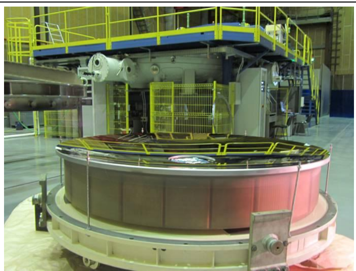
Рис. 3. Зеркало \text{\O}1120\text{мм} с отражающим покрытием, нанесенным на созданной установке.
