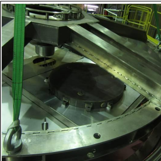
Рис. 2. Загрузка зеркала \text{\O}1150\text{мм} в вакуумную камеру установки.
