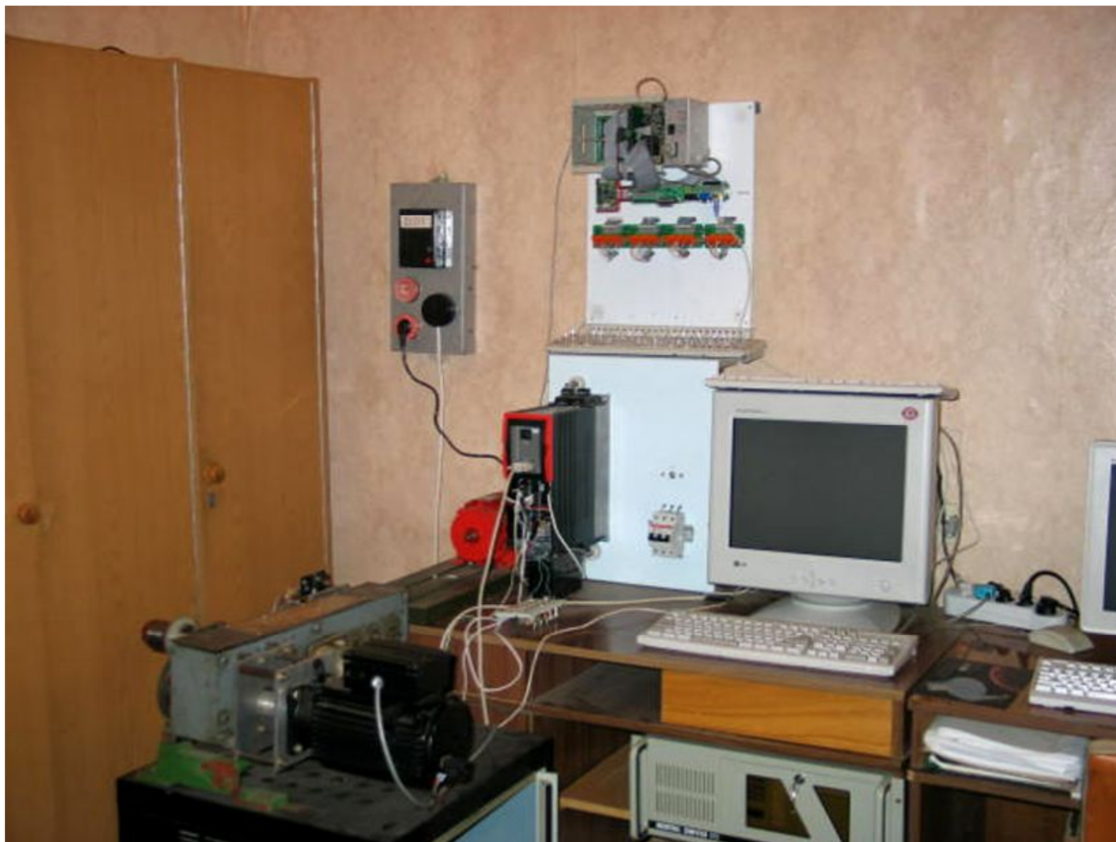
Физический макет для отработки алгоритма управления следящими приводами главного зеркала
